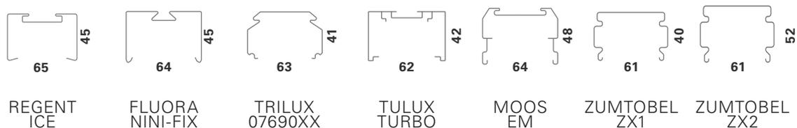
Unsere ONEline-SR ICE Systemleuchten bieten eine einfache, werkzeuglose Integration in diverse Lichtbandsysteme. Der Anschluss auf das bestehende Lichtbandsystem erfolgt über die mitgelieferte Netzverdrahtung und den Schneidekontaktclips. Die Kompatibilität ist nicht bei allen Tragschienen zu 100% gewährleistet. Eine vorgängige Bemusterung ist daher empfehlenswert.
