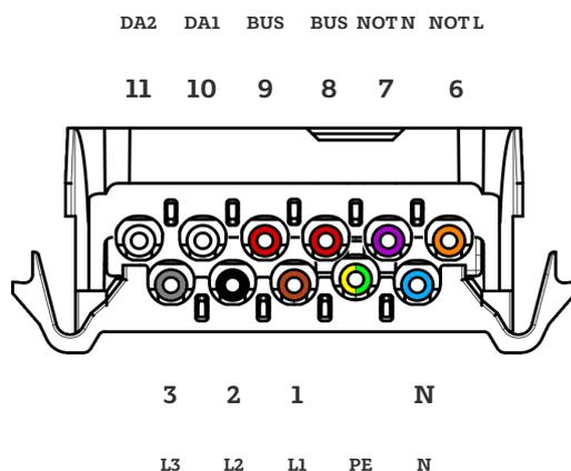
Die Durchgangsverdrahtung ist in verschiedenen Varianten erhältlich. Diese sind, einzeln oder bereits im Profil eingelegt, ab Lager lieferbar. Je nach Situation und Bedürfnis kann frei zwischen 5- bis 11-poliger Durchgangsverdrahtung gewählt werden.
